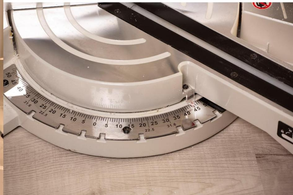
Запил для внутреннего соединения производится под углом 45 градусов
